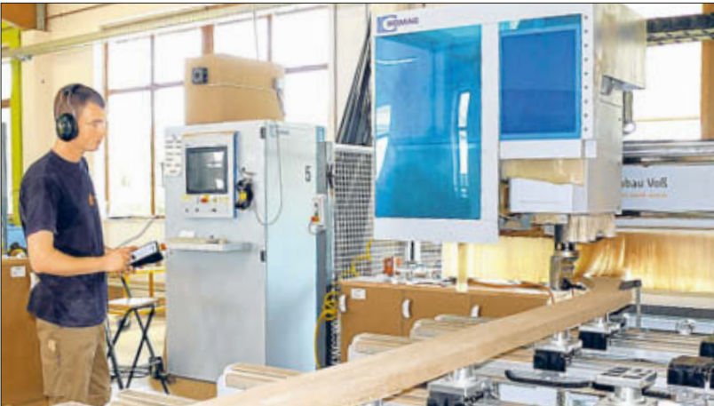
Stefan Pierstorff steuert eine große CNC-Maschine, die Löcher in Treppentwangen bohrt.
